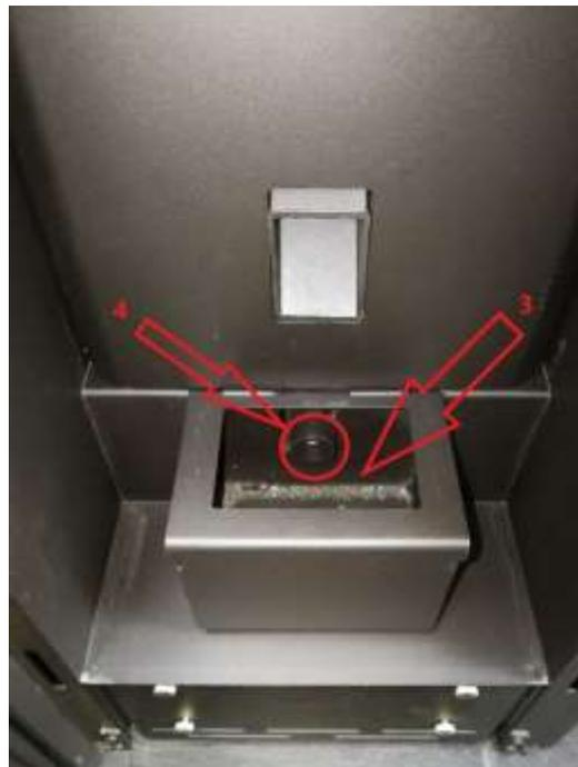
À chaque allumage, le brasier doit être vérifié si des cendres ou des granulés non brûlés sont présents. Les trous au fond du brasier doivent être libres afin de garantir un apport d'air en combustion correct.
