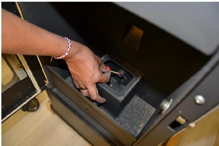
Si le teste de la bougie échoue, il faudrait procéder au remplacement de la bougie.
